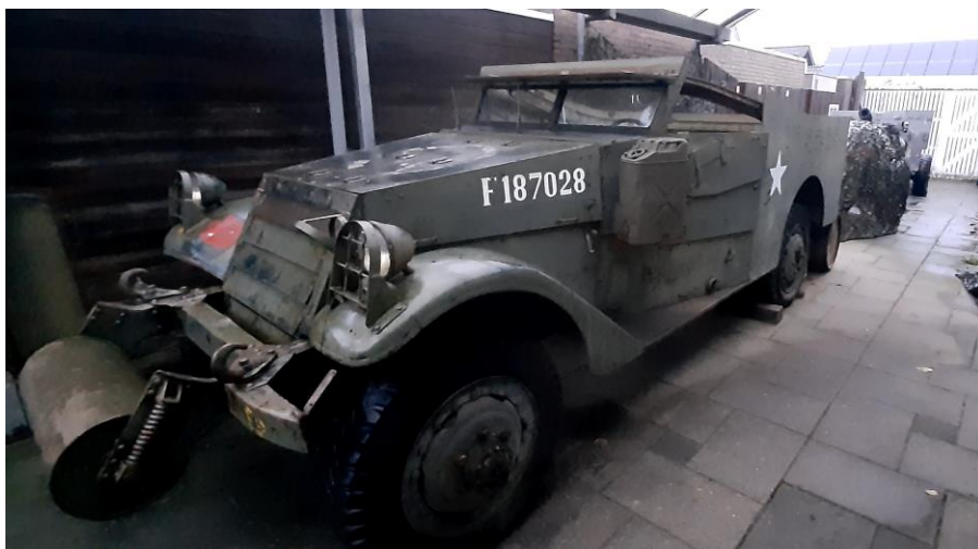
White Scoutcar. Bovenin de carrosserie een rail waar je diverse affuiten op kan bevestigen.
